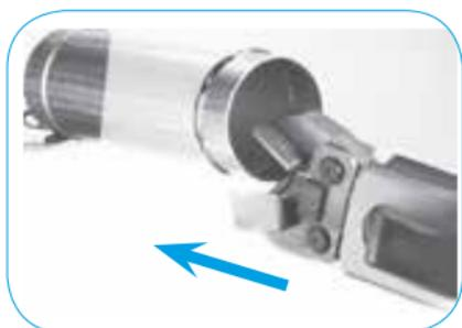
Ouvrir manuellement les 2 mâchoires de la pince. Insérer le tube aluminium dans la pince jusqu'en butée.
