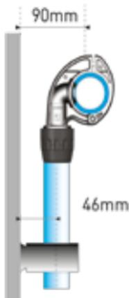
Pour les brides de dérivation Transair® Ø25 et Ø40, la distance séparant l'entraxe du tube et la cloison est égale à la distance séparant l'entraxe de la dérivation et la cloison, soit 46 mm.
