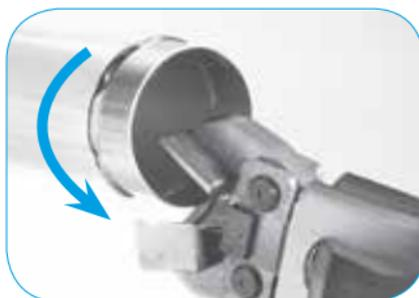
Ouvrir à nouveau les 2 mâchoires afin de ressortir le tube. Tourner légèrement le tube.
