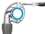
**4.** Serrer la vis avec la clé Allen Hex 5 mm ou Hex 3/16 pouce. Torque: 5-10 N.m
