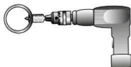
**1.** Percer le tube aluminium à l'endroit souhaité à l'aide de l'outil de perçage réf. **EW09 00 30, EW09 00 51, EW09 00 64.**
